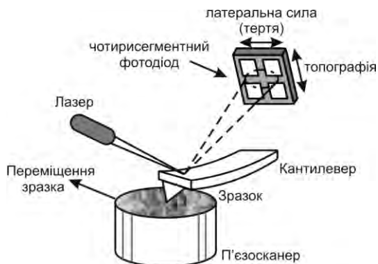
Рис. 7.20. Схема детектування відхилення кантилевера АСМ.
